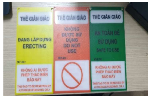
Giàn giáo được kiểm tra và treo thẻ: thẻ vàng đang lắp dựng, thẻ đỏ không được phép sử dụng, thẻ xanh an toàn sử dụng
